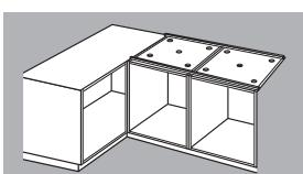
Tjek at der er luftventilation til bordpladens underside. Toppladen gennembøres med minimum 45 mm luftcirculationshuller – minimum 5 styk pr. skab.
