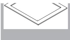
Ved evt. udskæring skal indvendige hjørner altid bores for med et Ø10 mm. bor, for at undgå revnedannelser. Den bedste måde at lave en udskæring i kompaktlaminat på, er ved hjælp af en overfræser. Til Mindre udskæringer kan med stor forsigtighed anvendes stiksav med metalklinge (uden brug af pendul).
