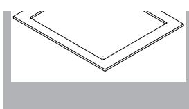
Ved utskjæringer må innvendige hjørne alltid borres for med Ø10 mm bor for å unngå revnedannelser. Den beste måten å gjøre en utskjæring på er ved hjelp av en overhåndsfreser. Til mindre utskjæringer kan man med stor forsiktighet bruke stikksag med metallklinge (uten bruk av pendul).
