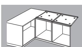
Sjekk at det er luftventilasjon til benkeplatsens underside. Topp platen gjennomborres med min. 45mm luftsirkulasjonshuller – min 5 stk pr skap.
