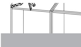
(gäller endast vid montering med "löse" underlagslister). Bänkskivor i kompaktlaminat kan levereras till montage med underlagslister. Underlagslister levereras som standard, i längder på 3650mm, med laminatkant på en långsida. Underlagslisterna kapas och tillpassas på plats.
